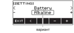
Пример: как указать тип батарей. Alkaline — щелочные батареи. Ni-MH — никель-металлогидридные аккумуляторы.
